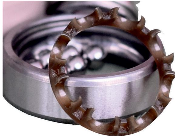
Подшипниковые модификации этих материалов обладают исключительно высокими характеристиками в условиях сухого (безсмазочного) трения, имеют низкий коэффициент трения  $\mu \leq 0,2$ , высокую износоустойчивость, низкое температурное расширение, сравнимое с металлами.
