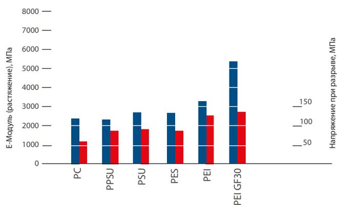
■ Модуль упругости при растяжении
