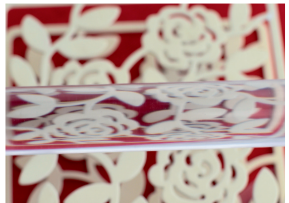
Заготовка из Поликарбоната после полировки
