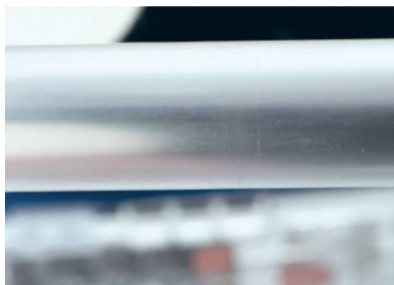
Заготовка из Поликарбоната после грубой шлифовки
