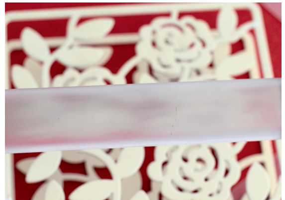
Заготовка из Поликарбоната после тонкой шлифовки
