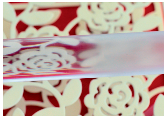
Заготовка из Поликарбоната (слева - отполированная часть, справа - после тонкой шлифовки)
