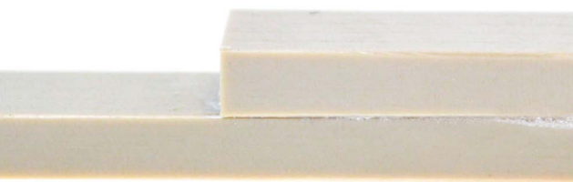
Склеенный PEEK 2 пластины (цианоакрилатный клей)
