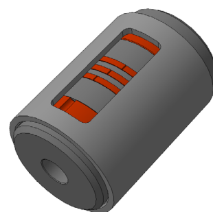
Компрессионные кольца в сжатом напряженном состоянии, установленные в цилиндр
